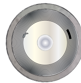
Beispielaufnahme einer Innenkontur mit Spanerkennung
