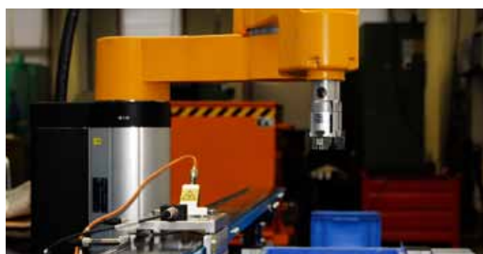
2D Robotergreifer bei der Teileentnahme
