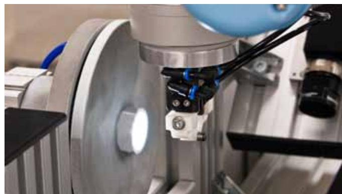
3D Robotergreifer beim Prüfen eines Innengewindes
